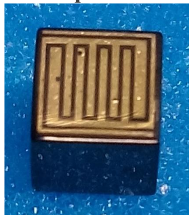
Образец 5x5x5 мм изготавливался по негативной технологии с осаждением золота из раствора по созданному рисунку
